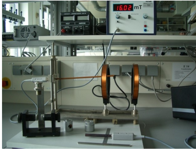
Bild 1: Versuchsaufbau zum Bestimmen magnetischer Felder [2]
